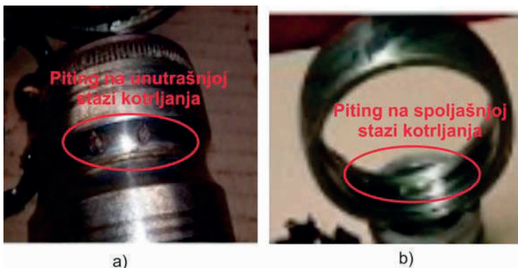
Slika 10. Izgled oštećenih ležaja nakon ispitivanja a) G_r=10 \mu\text{m} b) G_r=40 \mu\text{m}
