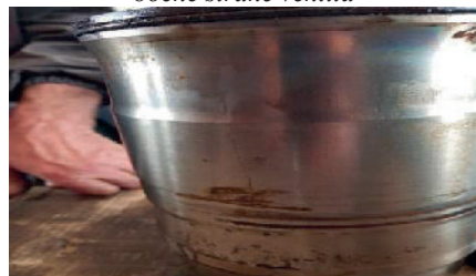
Slika 10. Pukotina umetka cilindra sa vidljivom površinom intenzivnog habanja
