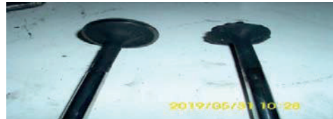
Slika 4. Polomljen izduvni ventil 3 - pogled sa strane tela ventila
