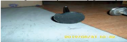
Slika 1. Polomljen izduvni ventil 1 -pogled sa strane pećurke
