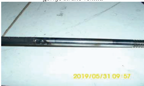
Slika 15. Pohabano stablo polomljenog izduvnog ventila
