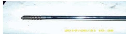
Slika 6. Pohabano stablo polomljenog izduvnog ventila 3
