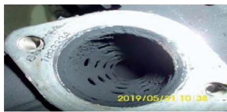
Slika 24. EGR ventil - pogled sa ulazne strane
