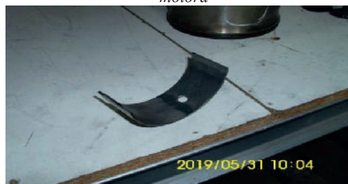
Slika 18. Deo ležaja velike pesnice klipnjače - vidi se njegovo oštećenje zbog habanja
