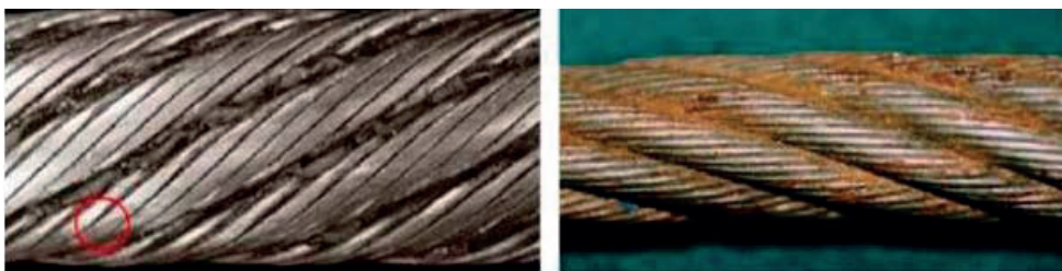
Slika 6. a) Savojni lom umora materijala užeta s spojnim nitima Slika 6. b) Korozijski oštećeno čelično uže
