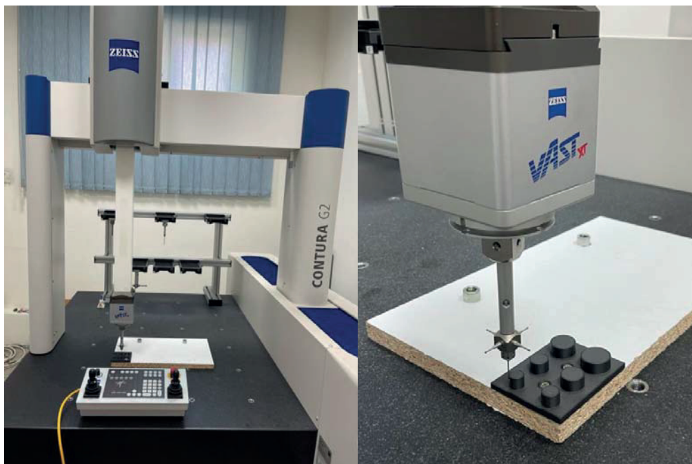
Slika 5. Mjerenje uzoraka pomoću CMMa Zeiss Contura G2 sa VAST XT mjernom sondom
