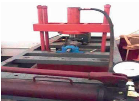
Slika 5. Eksperimentalna postavka ispitivanja ležaja na vibracije [1]
