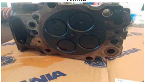
Slika 17. Polomljeni izduvni ventil i oštećena glava motora - pogled sa čeonice strane glave
