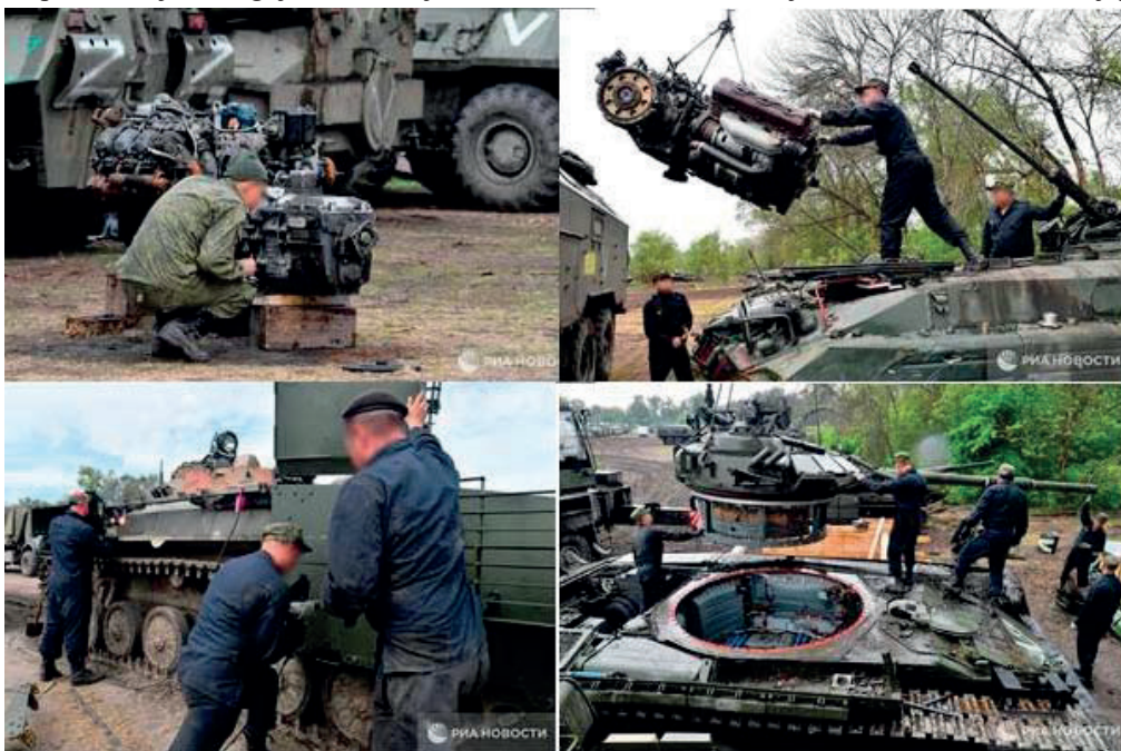
Slika 5. Zamjena ruskog tenkovskog motora i kupole u poljskim uslovima
