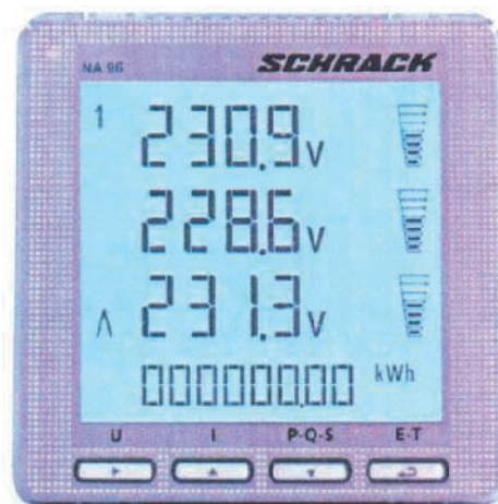
Slika 5. Analizator mreže na vratima ormana LVVFD [3]
