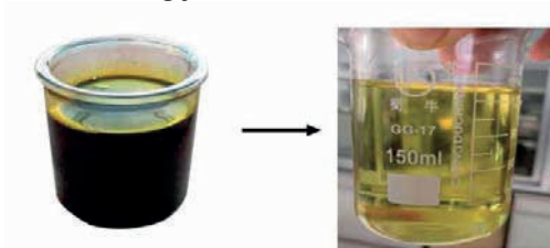
Slika 3. Razlika između otpadnog ulja i baznog ulja Grupe I dobivenog postupkom re-rafinacije otpadnog mazivog ulja
