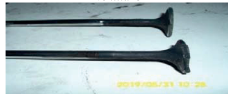
Slika 8. Polomljeni izduvni ventil 4 - pogled sa bočne strane ventila
