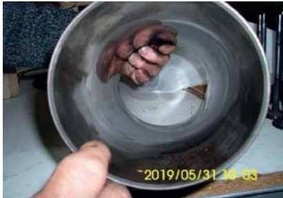
Slika 11. Unutrašnjost sa pukotinom umetka cilindra sa vidljivom površinom intenzivnog habanja
