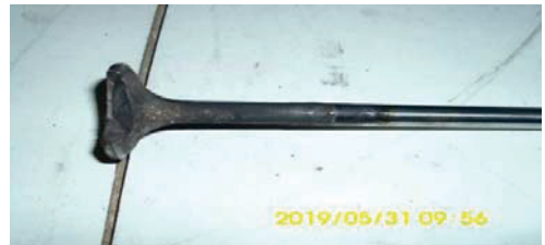
Slika 14. Polomljeni izduvni ventil - pogled sa bočne strane ventila
