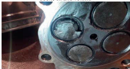
Slika 16. Polomljeni izduvni ventil i oštećena glava motora - pogled sa čeonice strane glave motora
