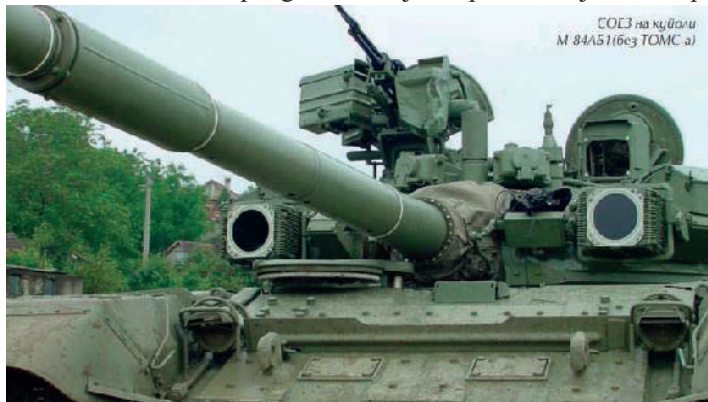
Slika 8. Spoljni elementi sistema za upravljanje vatrom na kupoli tenka M84
